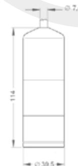
**Sensore immergibile per la misura di livello in acque reflue.**
