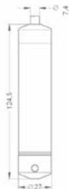
**Sensore di livello immergibile piezoresistivo di alta qualità con membrana in acciaio inox per la misurazione del livello dell'acqua potabile.**
