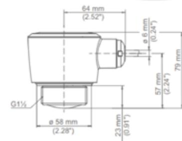
**Sensore radar 4 - 20mA o Modbus 0 - 15 m per la misura di livello senza contatto con l'acqua.**
